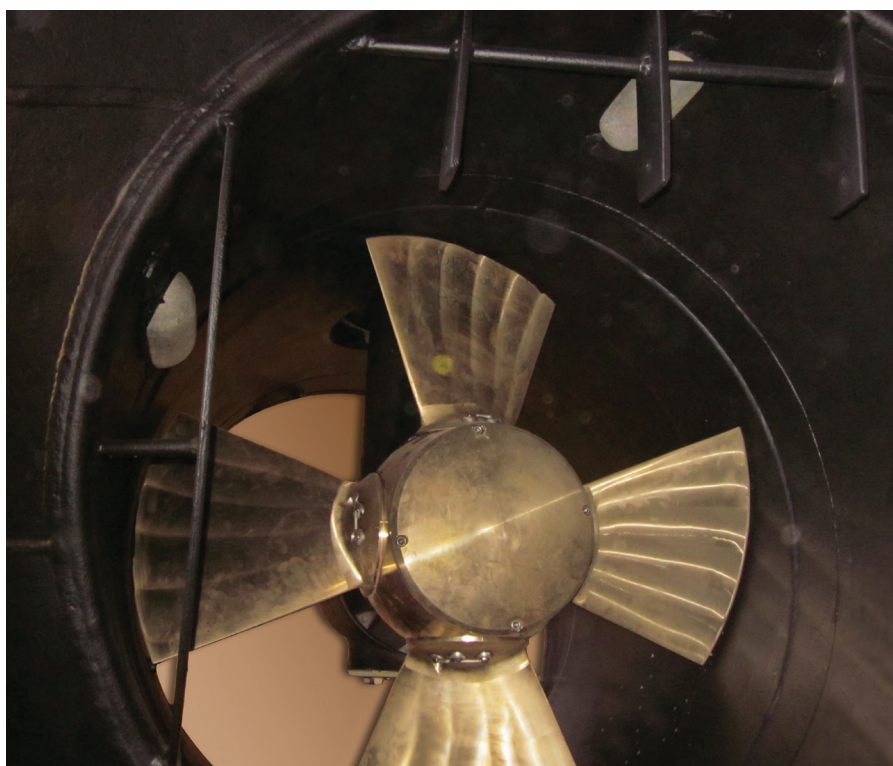
Tunnel thruster aboard the MV Fugløyhav
