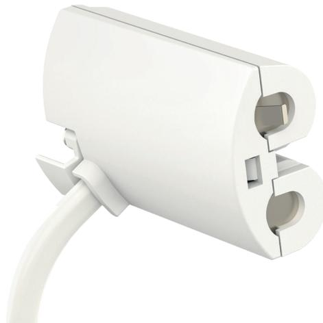
Das Danfoss Ally™ Power Module 24V ist ein Spannungsversorgungs-Modul zum Anschluss an ein bestehendes 24V Stromversorgungsnetz im Gebäude. Hierdurch ist ein Betrieb des elektronischen Heizkörperthermostats ohne Batterien möglich. Die Spannungsversorgung muss eine 24-V-Versorgung aus einer sicheren Quelle, mit einem Isolationsniveau der Klasse II sein (Stromversorgung mit eingebautem doppeltem oder verstärktem Isolationsniveau zwischen der Versorgungsspannung und der sicheren Spannung)
