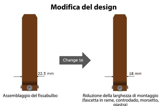
L'ambito di applicazione comprende tutti i fissabulbo utilizzati con i seguenti modelli Danfoss TXV: TU, TC, T2, TD1, TE5-55, TR6 e TGE, che interessano le seguenti sedi di produzione Danfoss TXV: Danimarca, Messico e Cina. L'elenco comparativo del fissabulbo di ricambio come materia prima si trova nella seguente tabella; se il fissabulbo è necessario come ricambio, il nuovo codice di vendita è riportato nella tabella alla pagina successiva.
