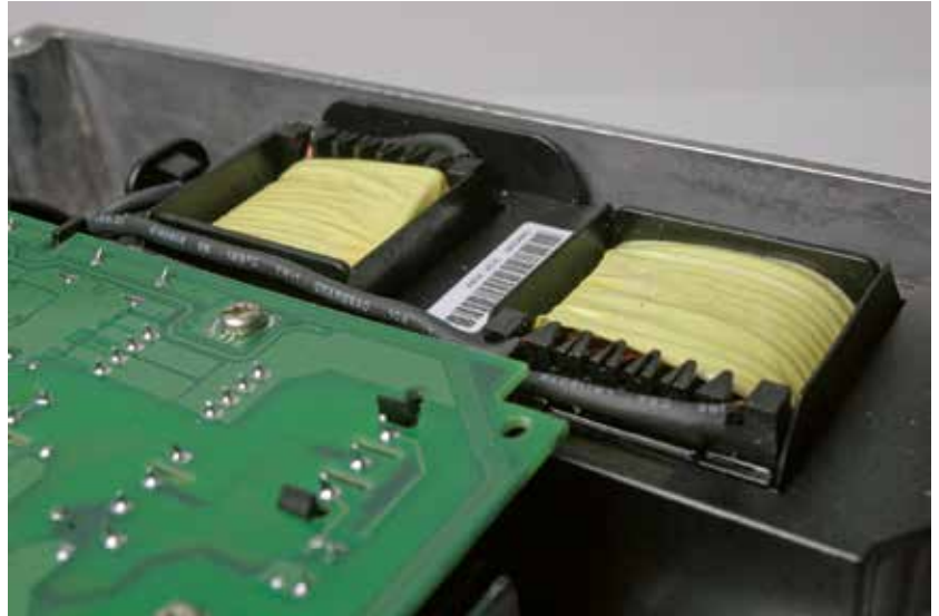
Eingebaute Zwischenkreisdrosseln reduzieren die niederfrequenten Netzrückwirkungen und erhöhen die Lebensdauer des Geräts.
