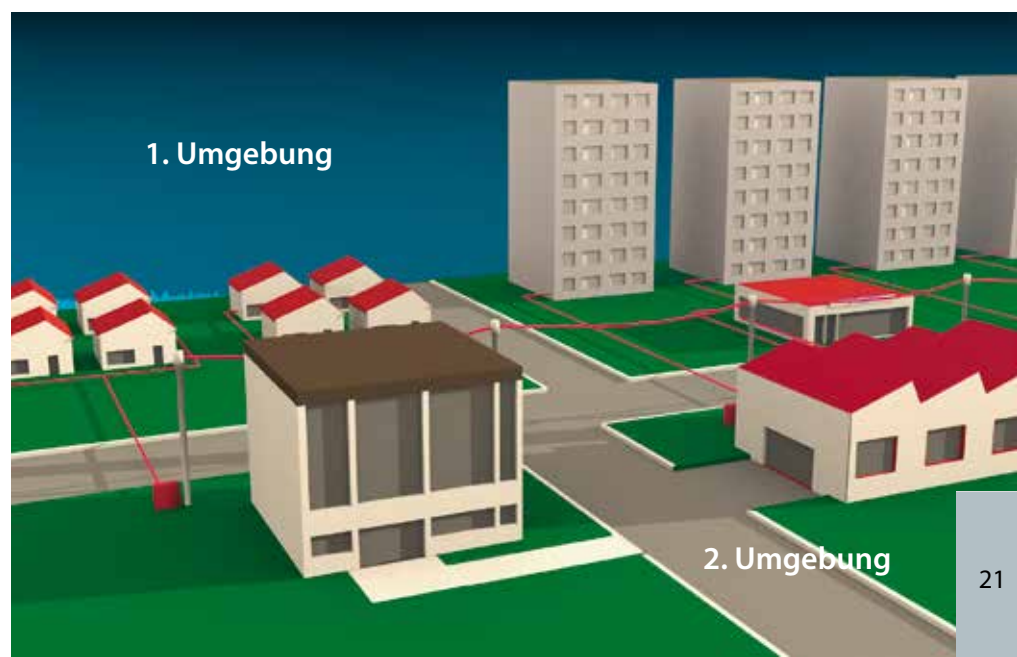
Einteilung der Einsatzbereiche in 1. und 2. Umgebung sowie Spezialbereiche, in denen der Betreiber die Wahl hat.
