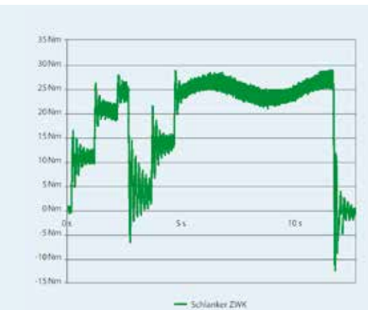
Bei Geräten mit schlankem Zwischenkreis steigt die Neigung zum „Schwingen“ bei größeren Lastwechseln
