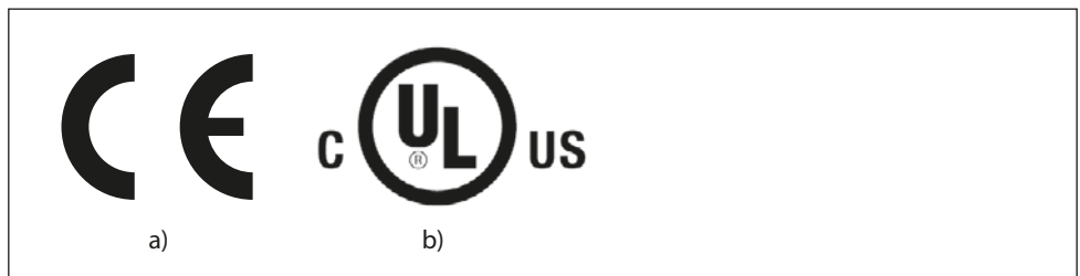
Abb. 2.28 CE-Kennzeichen (a) und ul-Listing (b)
