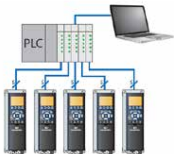
Fig. 9.8 Traditionele bedrading. Geen veldbus
