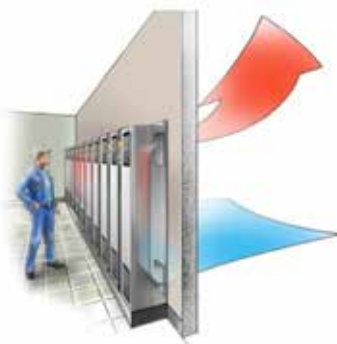
Fig. 10.7 Regelaars met backchannelkoeling
