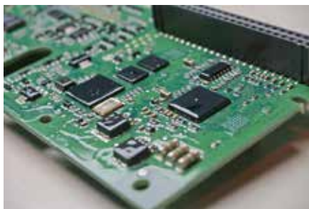
Fig. 10.12 Printplaat met vormvolgende coating
