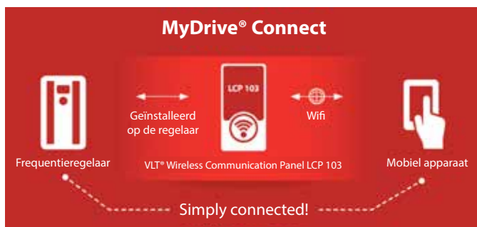
Fig. 9.3 VLT® Wireless Communication Panel LCP 103 verbindt de frequentieregelaar en het mobiele apparaat
