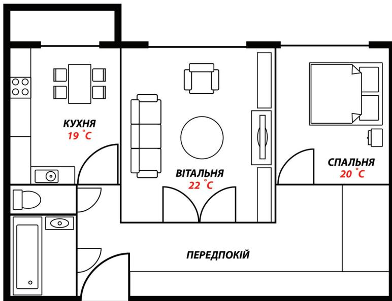
Установіть бажану температуру згідно з таблицею нижче. Терморегулятор автоматично підтримуватиме її, відкриваючи або закриваючи клапан залежно від того, достатньо в кімнаті тепла чи ні.
