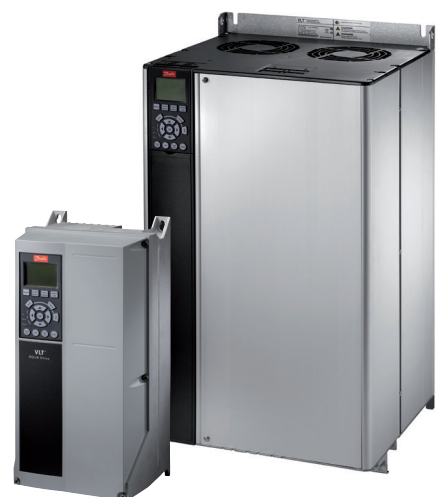
Berührungssichere Frequenzumrichter in den Schutzarten IP20 und 21 (rechts) sind für die Montage in Schaltschränken vorgesehen. Spritzwassergeschützte Frequenzumrichter in den Schutzarten IP54 und 55 (Bild links) sind für die Montage an Wänden oder auf Rahmen konzipiert.
