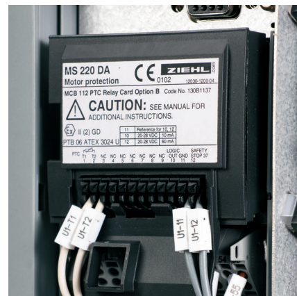
Die PTC Thermistor Optionskarte MCB112 kann, wie jede andere Option des VLT® AutomationDrive FC 302 auch, vor Ort schnell und kostengünstig per „Plug & Play“ nachgerüstet werden.
