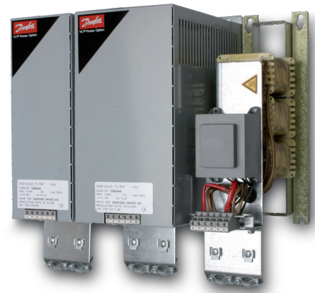
Ausgangsfilter IP20 (links) oder IP00 (rechts) reduzieren die Spannungsspitzen Upeak und die Spannungsanstiegsgeschwindigkeit dU/dt moderner Frequenzumrichter und schonen damit die Isolation des Motors.
