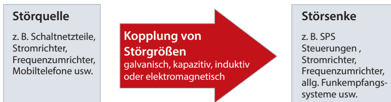
Überblick über die Kopplungswege elektromagnetischer Störgrößen und typische Beispiele
