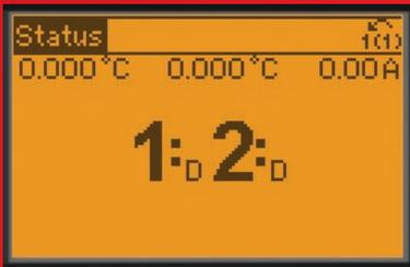
Ablese des Verdichterstatus direkt vom Display. D = Variable Drehzahlregelung, O = Aus, R = Netzbetrieb, X = Deaktiviert
