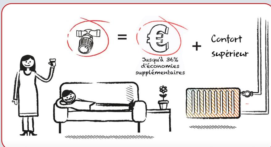
**Les corps thermostatiques de radiateurs** à pré-réglage assurent un équilibrage hydraulique sûr du système et évitent les sur-débites indésirables dans les radiateurs, ce qui permet de réaliser **jusqu'à 36% d'économies supplémentaires**, par rapport à des robinets de radiateurs manuels à ouverture constante ! Si votre thermostat a plus de 15 ans, le remplacer vous permettra de réaliser des économies importantes !
