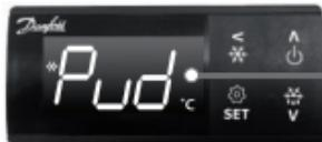
„Pud“: Wird drei Sekunden lang angezeigt und steht für eine Schnellabkühlung. Während der Schnellabkühlung wird das Schnellabkühlungssymbol angezeigt.
