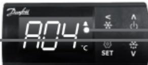
La température et les codes d'alarme clignotent en alternance jusqu'à ce que l'alarme soit résolue. La sonnette d'alarme s'affiche.
