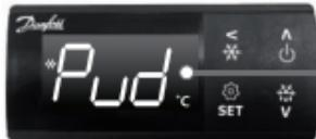
"Pud": отображается в течение 3 секунд для индикации захолаживания.
