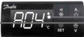
Die Temperatur- und Alarmcodes blinken abwechselnd, bis die Alarmursache behoben wurde. Die Alarmglocke wird angezeigt.
