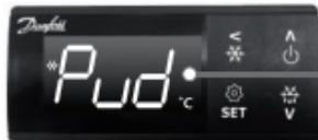
Przez 3 sekundy wyświetlany jest komunikat „Pud” sygnalizujący wychładzanie. Podczas wychładzania migają ikona WYCHŁADZANIA.
