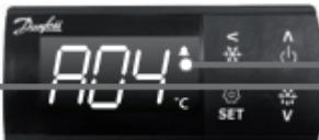
Коды температуры и тревожной сигнализации поочередно мигают до тех пор, пока сигнал тревоги не устранен. Отображается сигнальный звонок.
