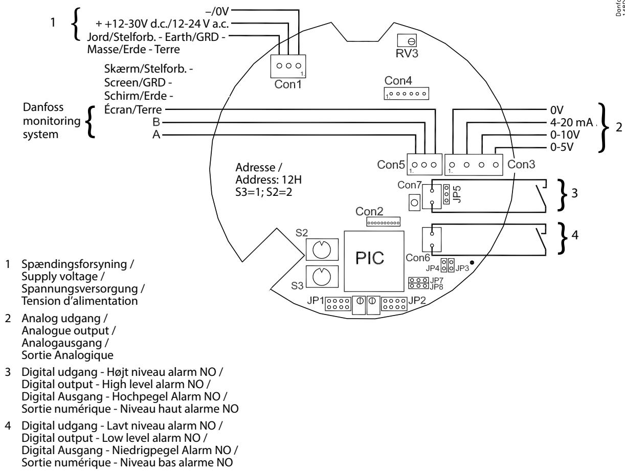
**Tilslutning af jumper på alle modeller / Jumper connection for all models / Steckbrückenanschlüsse für alle Modelle / Raccord cavalier pour tous modèles**
