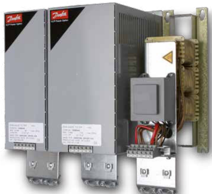
Ausgangsfilter IP20 (links) oder IP00 (rechts) reduzieren die Spannungsspitzen U_{peak} und die Spannungsanstiegsgeschwindigkeit du/dt moderner Frequenzumrichter und schonen damit die Isolation des Motors.
