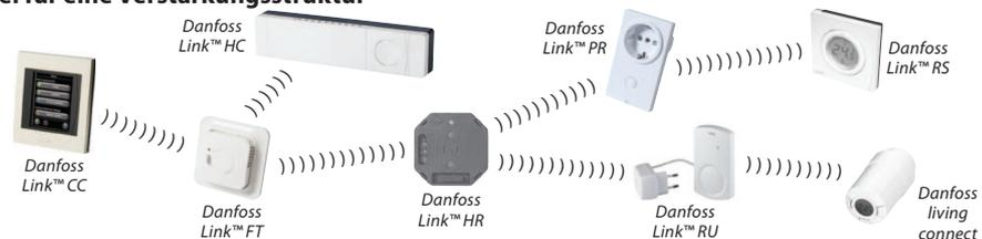
Zwischen Zentralregler und Empfänger können maximal drei Verstärker eingesetzt werden.
