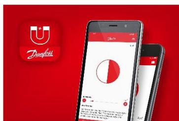
Con una pratica applicazione, Magnetic Tool, è possibile verificare se la bobina di un'elettrovalvola funziona correttamente. È sufficiente aprire l'applicazione, avvicinare lo smartphone alla bobina dell'elettrovalvola che si desidera testare e osservare la ruota dell'applicazione che inizia a girare. Se ruota, l'elettrovalvola è a posto. Lo strumento è incluso nell'applicazione Ref Tools e può essere scaricato qui: [Scaricare Ref Tools](#)
