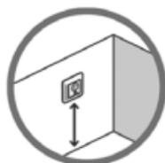
Platzieren Sie den Thermostat in geeigneter Höhe an der Wand (typischerweise in einer Höhe von 80 - 170 cm).
