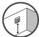
Platzieren Sie den Thermostaten in geeigneter Höhe an der Wand (in der Regel 80–170 cm).
