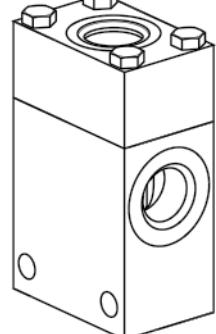
3. Ankerenheden "A" iskrues ventilhuset \*). Der spændes med et moment på 60 Nm ± 2 Nm.
