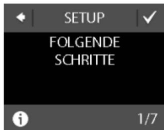
7. Mit den Pfeilen < und > können Sie auswählen, ob nur ein Bodenfühler oder eine Kombination von Raum- und Bodenfühlern verwendet werden soll. Drücken Sie zum Bestätigen auf .
