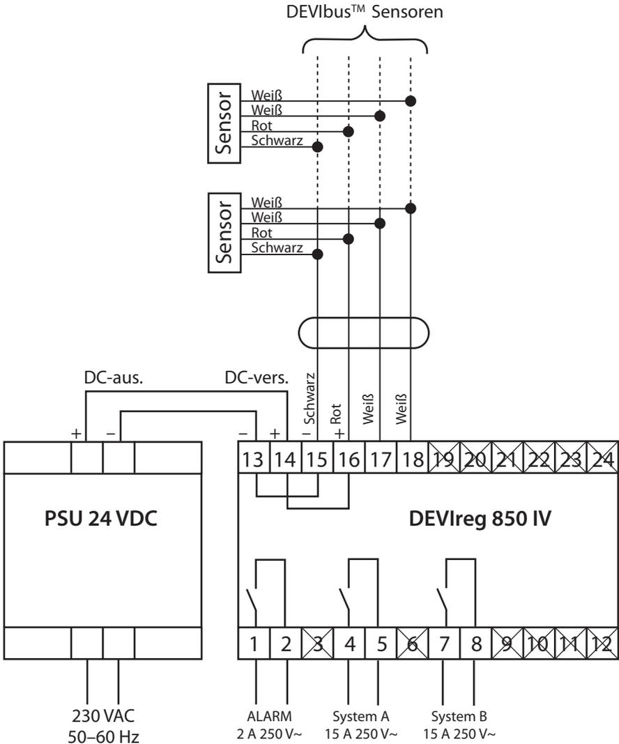
Der DEVIreg™ 850 besitzt eine integrierte Alarmfunktion, die die angeschlossenen Sensoren und den eingebauten Mikroprozessor überwacht.
