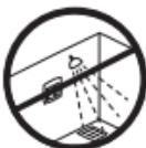
Termostat/spínač by sa nemal umiestňovať do vlhkých izieb. Termostat/spínač musí byť umiestnený mimo zóny 2. Umiestnite ho do susednej miestnosti a používajte výhradne podlahový snímač.
