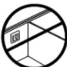
Termostat neumiestňujte na vnútornú stranu slabo izolovanej vonkajšej steny.
