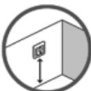
Termostat umiestnite do vhodnej výšky na stene (zvyčajne 80 – 170 cm). Spínač sa môže umiestniť na voľné miesto na stene.
