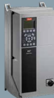
Las importantes variaciones de carga diaria en las plantas de tratamiento de agua dulce y aguas residuales hacen que sea económicamente ventajoso instalar variadores de frecuencia en equipos de rotación, como bombas y ventiladores. El Danfoss VLT® AQUA Drive FC 202 ofrece una configuración rápida y fácil de usar que reduce significativamente el tiempo de instalación y garantiza la máxima eficiencia energética.
