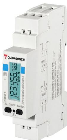
Le compteur d'énergie monophasé EM 511 peut être installé dans tout tableau électrique basse tension avec un courant nominal allant jusqu'à 45A pour surveiller la consommation d'énergie, les principales variables électriques et la distorsion harmonique.
