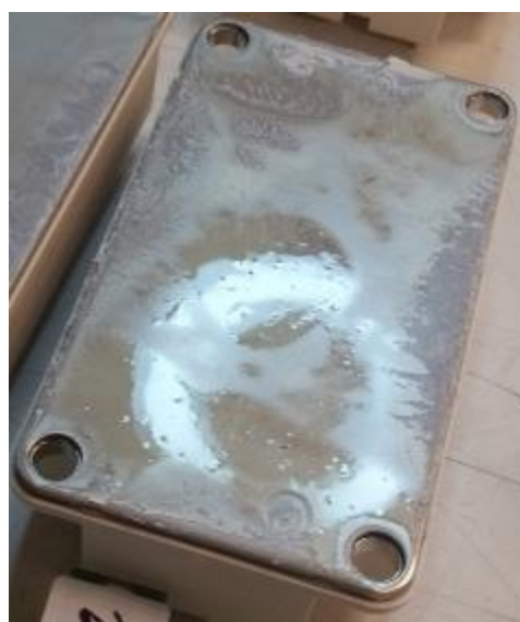
図 28: 市場に於ける、高温動作後のキャリアオイルとフィラーの分離を示す SEMİTRANS モジュールの裏面
