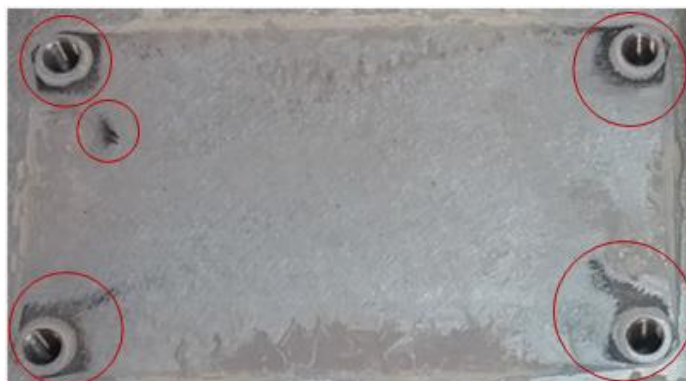
図 29: 激しい熱サイクルによるヒートシンクの黒い跡
