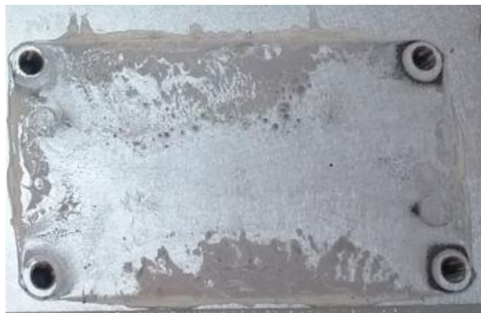
図 27: 熱サイクルを繰り返した後、SEMİTRANS モジュールの組付け位置に排出の兆候が見られる
