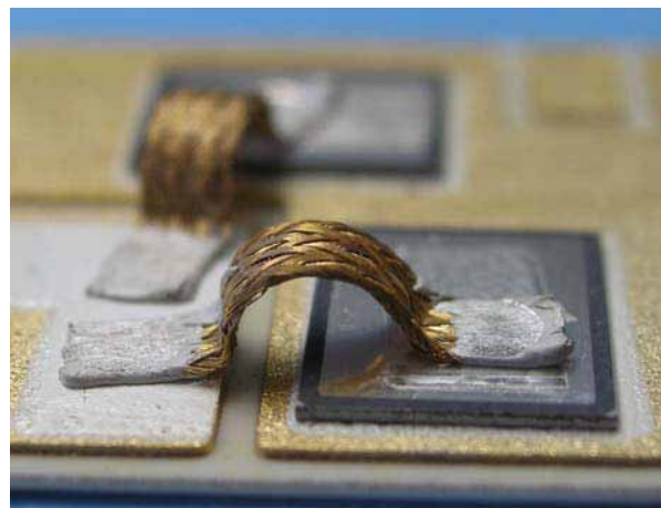
Bild 2.5.2 Gesinterte Silberbänder [31] oder Kupferlitzen [32] als Ersatz für klassische Bonddrahtverbindungen
