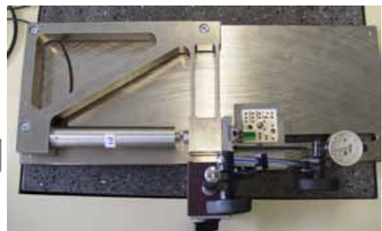
Bild 2.7.5 Prinzipzeichnung und Foto des Mikrovibrationstests; Beispiel: Test von MiniSKiiP-Federn
