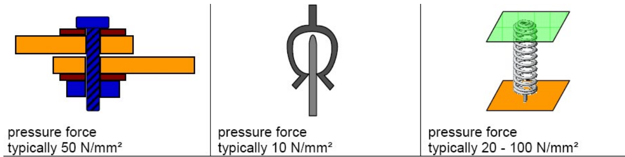
图 2.5.7 螺丝，插件和弹簧连接比较
