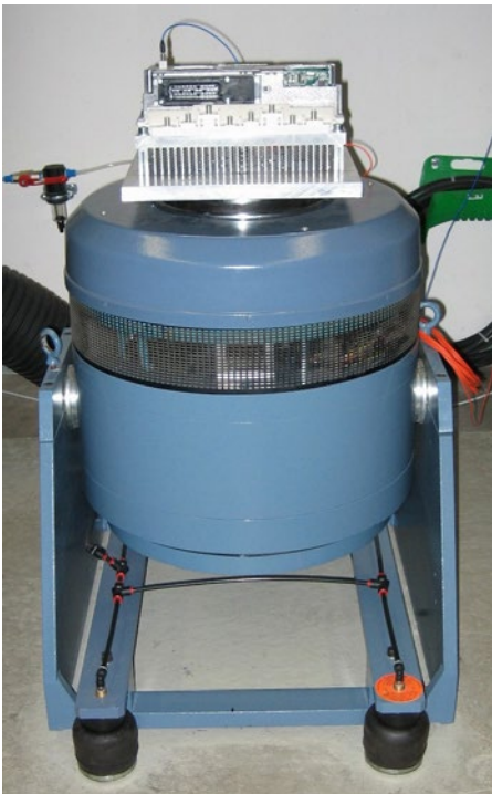
图 2.7.4 在震动试验板上的SKiiP系统
