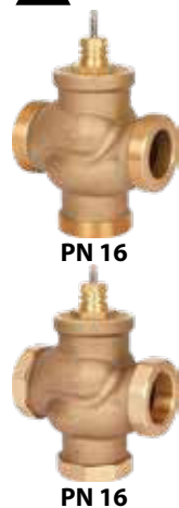
VRB 3 Vanne 3 voies à siège fileté en bronze Rg5, -10 à 130°C Caractéristique logarithmique
