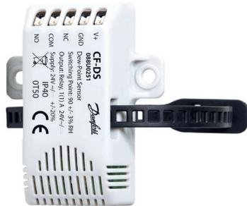
Der CF-DS misst die relative Luftfeuchtigkeit im Verhältnis zur Rohrtemperatur. Bei 90 % RH sendet der Taupunktfühler ein Signal zum Icon2™-Hauptregler, wodurch die Kühlung unterbrochen wird.
