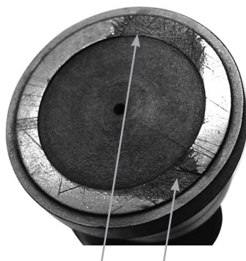
Usure abrasive des têtes de piston. Tous les pistons doivent être remplacés immédiatement.
