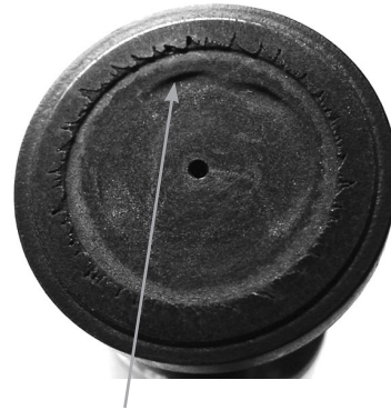
Cavitation des têtes de pistons. Tous les pistons doivent être remplacés d'ici 500 à 1 000 heures.
