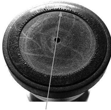
Cavitation des têtes de pistons. Une nouvelle inspection est requise dans 3 000 à 4 000 heures.
