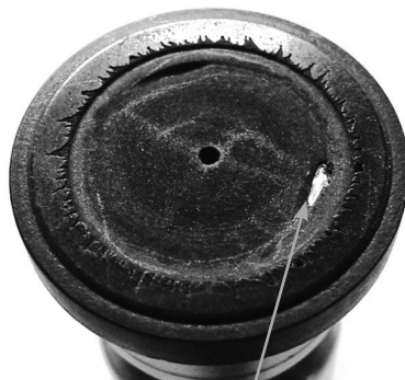
Cavitation des têtes de pistons. Tous les pistons doivent être remplacés d'ici 100 à 200 heures.
