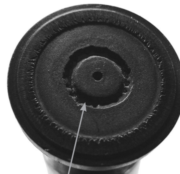
Cavitation des têtes de pistons. Tous les pistons doivent être remplacés immédiatement.
