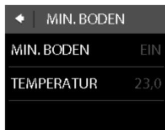
4. Drücken Sie auf **TEMPERATUR**. Verwenden Sie anschließend die Pfeile < und >, um die Mindest-Bodentemperatur einzustellen. Drücken Sie zum Bestätigen
