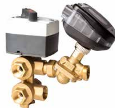
↑ Danfoss NovoCon®, montiert auf AB-QM, regelt sowohl den Durchfluss durch das PICV-Ventil als auch die Position des CO6-Stellantriebs, der auf dem 6-Wege-Umschaltventil für Heizen/Kühlen montiert ist.
