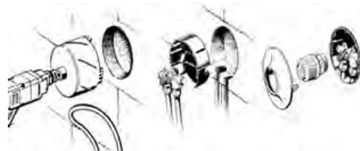
Regulace teploty podlahy u kombinovaného systému topná smyčka s ventilovým tělesem FHV-R ve vratném potrubí.
