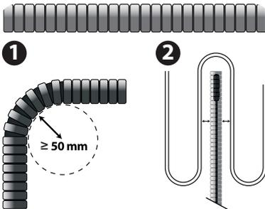
Verlängerung der Fühlerverdrahtung muss in der gleichen Art und Weise erfolgen wie eine normale Netzspannungsverkabelung.
