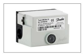
Le régulateur à microprocesseur OBC 84.10 offre des temporisations stables et précises, indépendamment des variations de la tension d'alimentation et de la température ambiante. Le régulateur est protégé contre les soustensions conformément à la norme EN 298:2012. En cas de sous-tension, le régulateur empêchera le brûleur de démarrer et, simultanément, un code clignotant s'affichera. De plus, en cas
