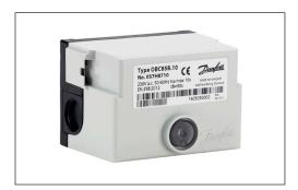
Le régulateur à microprocesseur OBC 85B.10 offre des temporisations stables et précises, indépendamment des variations de la tension d'alimentation et de la température ambiante. Le régulateur est protégé contre les soustensions conformément à la norme EN 298:2012. En cas de sous-tension, le régulateur empêchera le brûleur de démarrer et, simultanément, un code clignotant s'affichera. De plus, en cas
