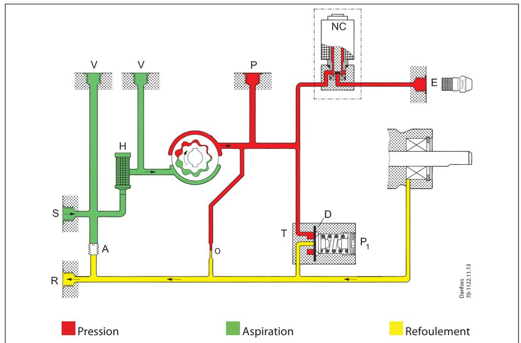
Au démarrage de la pompe, le fioul est aspiré depuis la conduite d'aspiration (S) à travers le filtre (H) jusqu'à l'engrenage (C).
