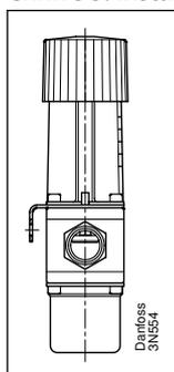
Ces vannes peuvent être montées dans n'importe quelle position. Une flèche sur le corps de vanne indique le sens du débit. Les vannes FJVA sont également marquées de façon à ce que les lettres RA puissent être lues directement. Il est recommandé d'installer un filtre de type FV en amont de la vanne.
