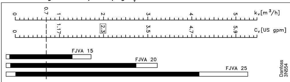
Les valeurs  $K_v$  sont toujours données pour le débit d'eau en [m<sup>3</sup>/h] avec une chute de pression  $\Delta p$  de 1 bar. La vanne doit être sélectionnée de façon à ce que la valeur  $k_v$  nécessaire figure au milieu de la plage de régulation.
