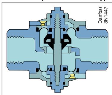
Les vannes de ce type fonctionnent avec des constantes de temps plus longues que les vannes AVTA pour lesquelles la sonde est placée à l'endroit où la température doit être régulée. La FJVA est essentiellement utilisée dans les systèmes sans changements de charge importants et soudains.
