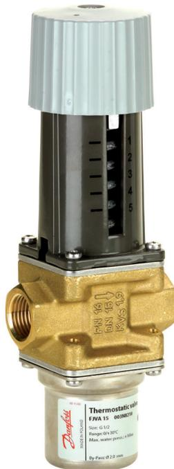
Les vannes thermostatiques à eau sont utilisées pour la régulation continue proportionnelle du débit en fonction du réglage et de la température du capteur.
