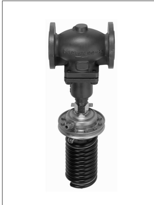
该控制器是自力式压力控制器，主要用于暖通空调及区域能源。控制器平时关闭，当阀前压力超过设定值时开启。
