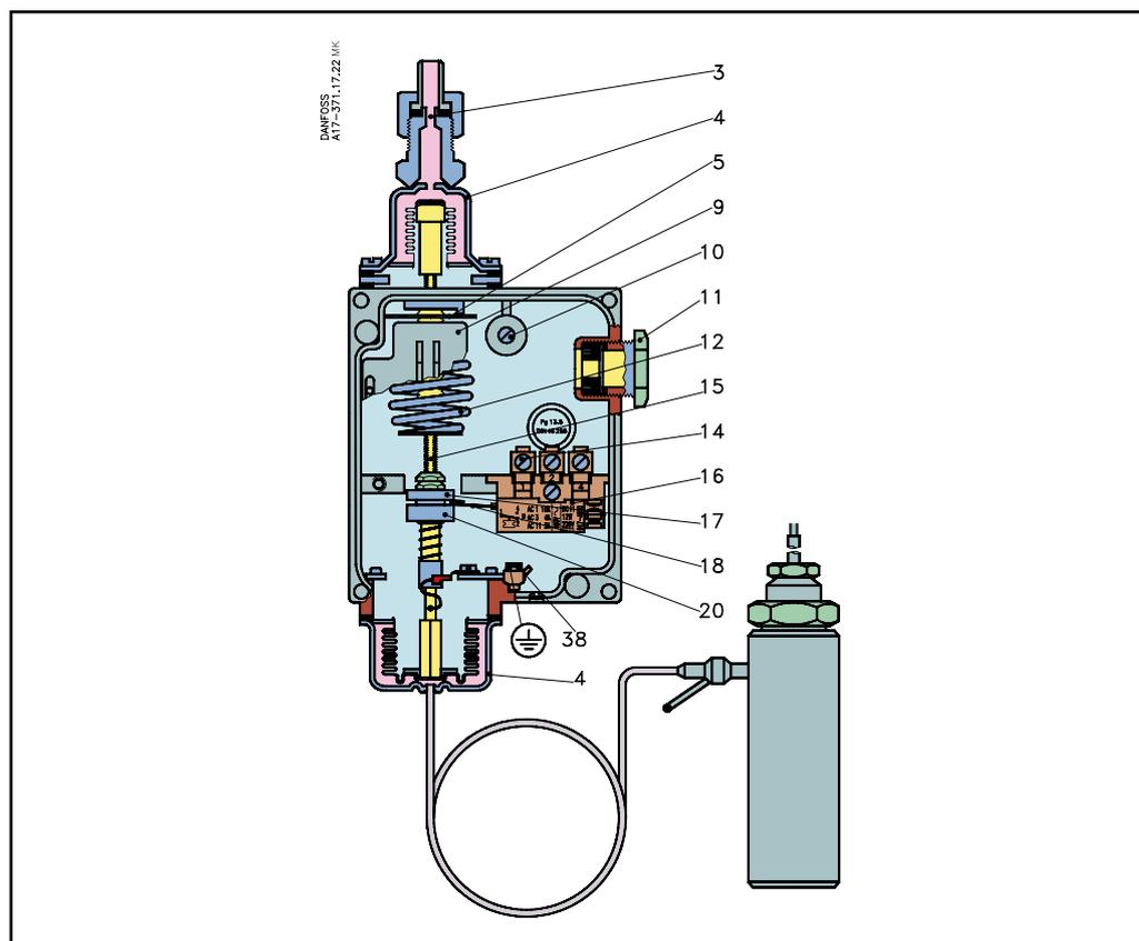
O RT 280A e o RT 281A são baseados no RT 260A. O elemento inferior é térmico e possui um bulbo aquecido eletricamente. Como indicado, as unidades são principalmente para uso como alarmes de nível de líquidos e chaves de segurança. Na concepção das unidades, a ênfase foi colocada na função à prova de falhas. No caso de um defeito do elemento térmico, o compressor para e a injeção de líquidos é cortada. A reinicialização apenas é possível após o defeito ser corrigido.
