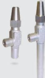
Die Nadelventile aus Edelstahl (SNV-SS) sind kompakte und leichte Serviceventile. Sie sind aufgrund ihrer robusten Bauweise und ihrem hohen Maß an Betriebssicherheit besonders für harte industrielle Einsatzbedingungen geeignet. Ihr Design sorgt für eine gute Durchflusseigenschaft. Die SNV-SS Ventile haben einen maximalen Betriebsüberdruck von 52 bar im Temperaturbereich von -60 °C bis +150 °C.
