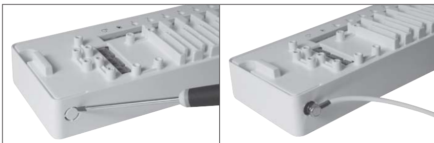
Krok 9) Montaż anteny zewnętrznej.
