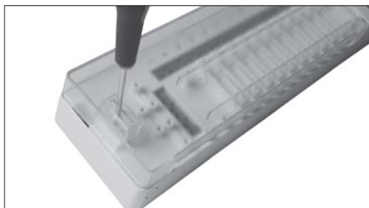
Krok 1) Demontaż pokrywy frontowej.
