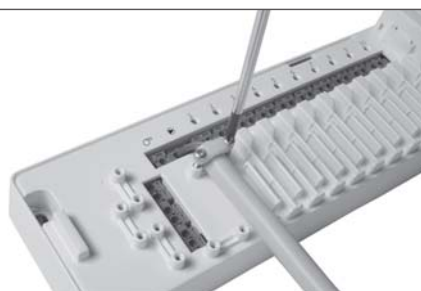
Krok 6) Podłączanie przewodu do sterowania pracą pompy obiegowej.
