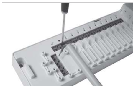
Krok 6) Podłączanie przewodu do sterowania pracą pompy obiegowej.
